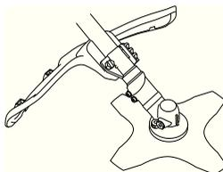
Проверьте, чтобы защита не была повреждена и чтобы на ней не было трещин. Замените защиту, если она была подвержена удару или если на ней есть трещины.
