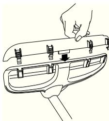
Дополнительное ограждение легко снимается с помощью отвертки, см. рис.
