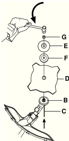
Установка щитка и триммерной головки
