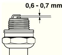
**ВНИМАНИЕ!** Всегда используйте только указанный тип свечи! Применение несоответствующей модели может привести к серьезным повреждениям поршня/цилиндра. Следите за тем, чтобы свеча была оснащена т.н. изоляцией радиопомех.
