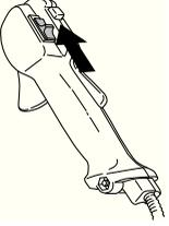
Motoru çalıştırınız ve stop düğmesi stop durumuna getirildiğinde motorun durduğunu denetleyiniz.
