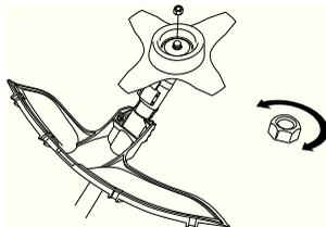
При сборке надо затягивать гайку против направления вращения режущего оборудования. При разборке надо отвинчивать гайку в направлении вращения режущего оборудования. (ЗАМЕЧАНИЕ! Гайка имеет левостороннюю резьбу.) Затяните гайку торцевым гаечным ключом.
