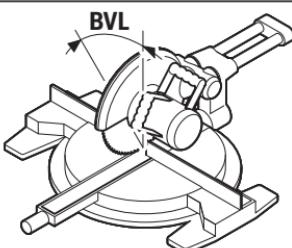
Stiskněte znovu tlačítko 7. Na displeji se objeví „**BVL**“ a vypočítaný vertikální úhel sklonu pro kapovací a pokosovou pilu.
