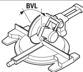
Ponownie wcisnąć przycisk **7**. Na wyświetlaczu pojawi się „**BVL**“ i wyliczony pionowy kąt cięcia dla ukośnic.
