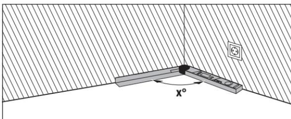
Ako radni komadi treba da se stave napasuju u ugao (na primer za letve za podove), onda izmerite ugao čoška **x°** naleganjem preklapljenog i baznog kraka. Za zadate uglove (na primer okvire za slike) otvorite preklapljene i bazne krakove toliko, sve dok se na prikaze na displeju prikaže željeni ugao.
