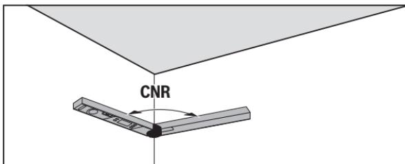
За определяне на наклона на детайлите допрете разгъващото се рамо и основното рамо пътно до стените или непосредствено настройте ъгъла, ако е известен.
