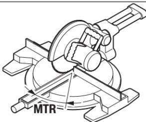
Nyomja meg ismét a **7** gombot. A kijelzőn megjelenik az „**MTR**” és a számított vízszintes sarkalóság a rövidítő és sarkaló fűrész számára.
