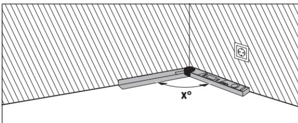
Mají-li být obrobky vsazeny do rohu (např. pro podlahové lišty), pak změřte úhel rohu **x°** přiložením sklopného ramene a ramene základny. Pro zadání úhly (např. rámy obrazů) rozevřete sklopné rameno a rameno základny naplak, až se na displeji zobrazí požadovaný úhel.
