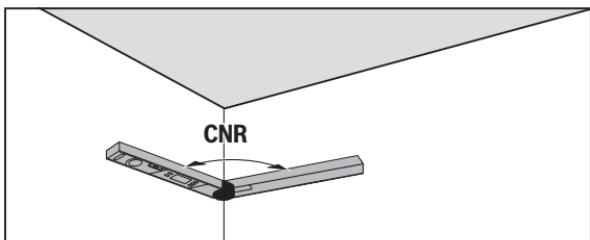
Для вимірювання кутового кута покладіть складне і базове плече всією поверхнею до стіни або налаштуйте відомий кутовий кут на вимірювальному інструменті.
