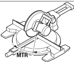
Нажмите на кнопку «**MTR**» 8. До тех пор, пока Вы нажимаете на кнопку «**MTR**» 8, будет отображаться рассчитанный горизонтальный угол скоса «**MTR**», который нужно настроить на торцовочно-усорезной пиле. Одновременно на дисплее загорается индикатор «**MTR**».
