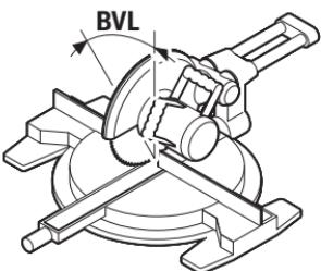
Stlačte znova tlačidlo 7. Na displeji sa zobrazí „**BVL**“ a vypočítaný vertikálny uhol zošikmenia pre kapovaciu a pokosovú pílu.
