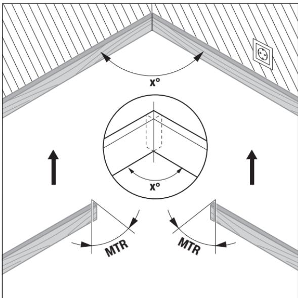
Изчислява се ъгълът на скосяване в хоризонтална равнина «MTR» («Miter Angle»: ъгъл на скосяване в хоризонтална равнина), под който трябва да бъдат отрязани двата детайла. При отрязването циркулярен диск е перпендикулярен на детайла (ъгълът на скосяване във вертикална равнина е  $0^\circ$ ).
