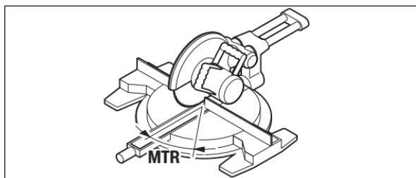
Знову натисніть кнопку **7**. На дисплей висвічується «**MTR**» і вирахуване значення горизонтального кута розпилювання для торцювально-вусорізної пилки.
