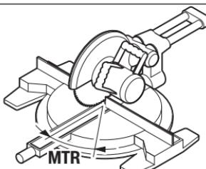
Pritisnite tipko „MTR“ 8. Dokler držite pritisnjeno tipko „MTR“ 8, bo prikazan izračunan vodoraven kot zajere „MTR“, ki ga je treba nastaviti na čelilni in zajeralni žagi. Istočasno sveti indikator „MTR“ na prikazovalniku.
