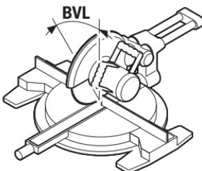
Одново притиснете го копчето **7**. На екранот се појавуваат „**BVL**“ и пресметаните вертикални агли на закосување за пилата за отсекување и сечење под агол.
