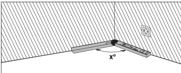
Dacă piesele de lucru trebuie potrivite într-un colț (de ex. pentru plinte), atunci măsurati unghiul de colț  $x^\circ$  prin așezarea riglei mobile și a celei fixe. Pentru unghiiuri preseritte (de ex. rame de tablouri) desfaceți într-atât rigla mobilă și cea fixă până când unghiul dorit va fi afișat pe display.
