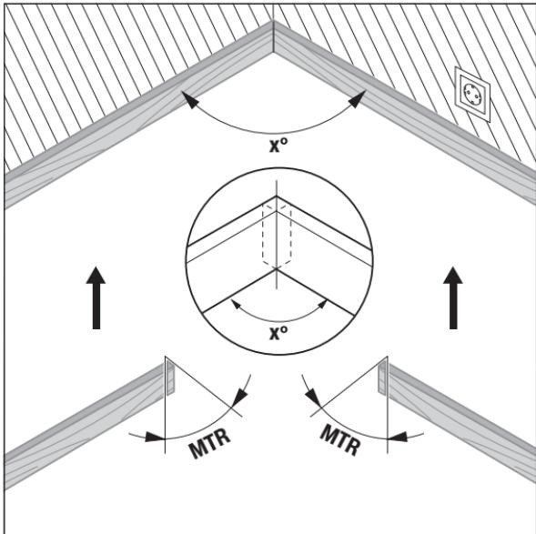
Izračunava se horizontalni kut kosog rezanja „**MTR**“ („Miter Angle“: hori-zontalni kut kosog rezanja), za skraćenje dva izratka. Kod ovih rezova pod kutom kosog rezanja, list pile se nalazi okomito na izradak (vertikalni kut kosog rezanja iznosi  $0^\circ$ ).
