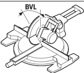
Ponovno pritisnite tipku **7**. Na displeju će se pojaviti „**BVL**“ i izračunat vertikalni kut kosog rezanja za pilu za odrezivanje i koso rezanje.
