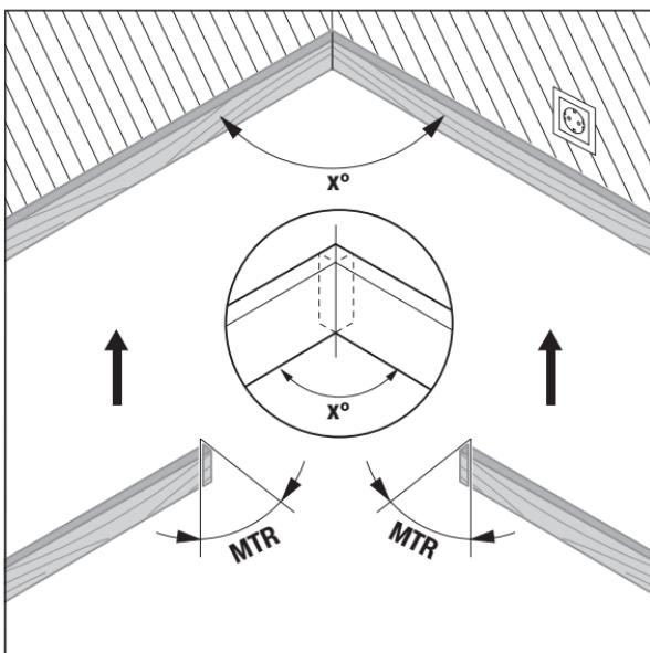
Vypočítán bude horizontální úhel pokusu „**MTR**“ („Miter Angle“: horizontální úhel pokusu), o který musejí být zkráceny oba obrobky. Pilový kotouč stojí u těchto pokosových řezů kolmo vůči obrobku (vertikální úhel sklonu činí  $0^\circ$ ).
