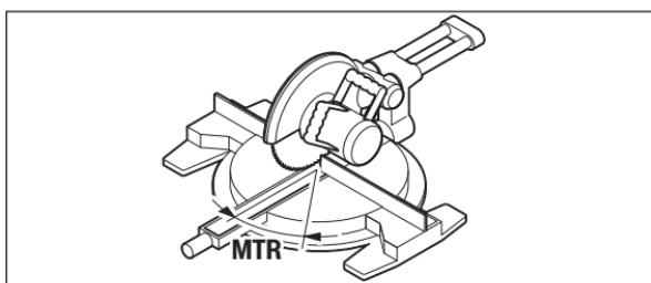
Одново притиснете го копчето **7**. На екранот се појавуваат „**MTR**“ и пресметаниот хоризонтален агол на закосување за пилата за отсекување и сечење под агол.
