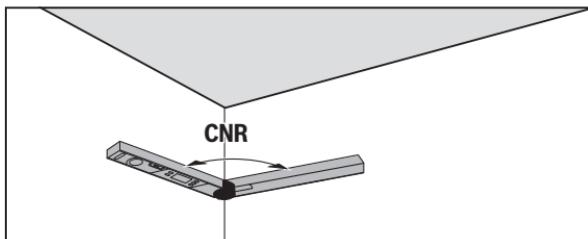
Na zmeranie rohového uhla priložte sklápacie a základné rameno plochou na steny alebo na meracom prístroji nastavte známy rohový uhol.
