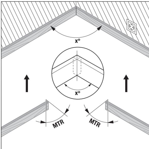
Se calculează unghiul de înclinare în plan orizontal „**MTR**“ („Miter Angle“, unghi de inclinare în plan orizontal), în care se vor tăia cele două piese de lucru. La aceste tăieri oblice pânza de ferăstrău este perpendiculară pe pie- sa de lucru (unghiul de inclinare în plan vertical este de  $0^\circ$ ).
