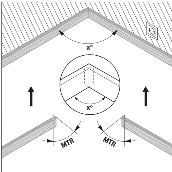
Екі дайындаш қысқаратын „MTR“ („Miter Angle“: горизонталды қисаю бұрышты) горизонталды қисаю бұрышы есептеледі. Ара полотносы осы қисаю бұрыштарда дайындаға көлденен тұрады (вертикалды қисаю бұрышы  $0^\circ$ ).
