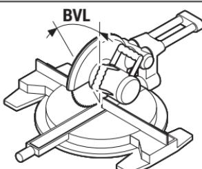
Nyomja meg ismét a **7** gombot. A kijelzőn megjelenik a „**BVL**” és a számított függőleges sarkalóság a rövidítő és sarkaló fűrész számára.
