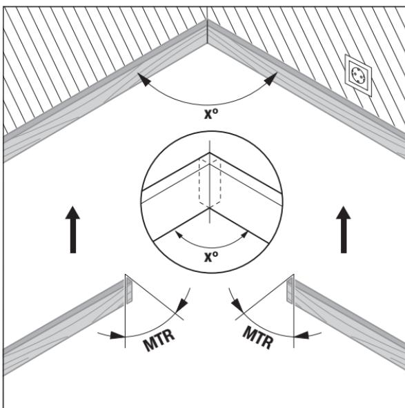
Ako se izračunava horizontalni ugao iskošenja „MTR“ („Miter Angle“: horizontalni ugao iskošenja), oko kojeg se moraju skratiti dva radna komada. List testere stoji kod ovih uglova iskošenja vertikalno na radni komad (vertikalni ugao iskošenja iznosi  $0^\circ$ ).
