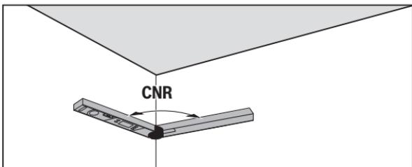
Aby pomierzyć narożnik należy ramię stałe i ramię odchylane przyłożyć pasko do ścian lub ustawić na urządzeniu pomiarowym znany kąt.
