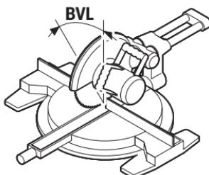
Натиснете отново бутона **7**. На дисплея се появяват символът «**BVL**» и изчисленияят ъгъл на скосяване във вертикална равнина за циркулярна машина.
