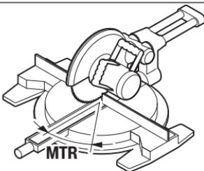
Натиснете бутона «**MTR**» 8. Докато държите натиснат бутона «**MTR**» 8, се изобразява изчисленият хоризонтален ъгъл на скосяване «**MTR**», който трябва да бъде настроен на циркулярната машина. Същевременно на дисплея светва индикаторът «**MTR**».
