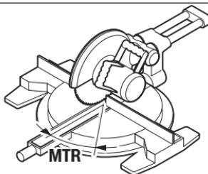
Stlačte tlačidlo „MTR“ **8**. Pokiaľ tlačidlo „MTR“ **8** podržíte stlačené, zobrazí sa vypočítaný horizontálny uhol zošikmenia „MTR“, ktorý je potrebné nastaviť na kapovacej a pokosovej píle. Súčasne sa na displeji rozsvieti indikátor „MTR“.
