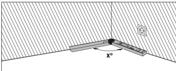
Ak majú byť dva obrobky zapasované do kúta (napríklad podlahové lišty), potom odmerajte rohový uhol  $x^\circ$  priložením sklápacieho a základného ramena. Pre vopred stanovené uhly (napríklad rámy obrazov) otvorte sklopacie a základné rameno natol'ko, aby sa na displeji zobrazil požadovaný uhol.
