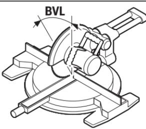
Вновь нажмите кнопку **7**. На дисплее отображается «**BVL**» и рассчитанный вертикальный угол распила для торцовочно-усорезной пилы.
