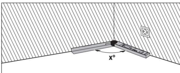
Ako se izraci trebaju pripasati u ugлу (npr. za podne letvice), u tom slučaju izmjerite kut u ugлу  $x^\circ$  polaganjem preklopnog i osnovnog kraka. Za pret-hodno zadani kut (npr. okvir za sliku) otvorite preklopni i osnovni krak toli-ko dok se na displeju ne pokaže traženi kut.
