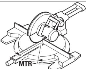
Apăsați din nou tasta **7**. Pe display apar „**MTR**“ și unghiul de înclinare în plan orizontal calculat pentru ferăstrăul circular staționar.
