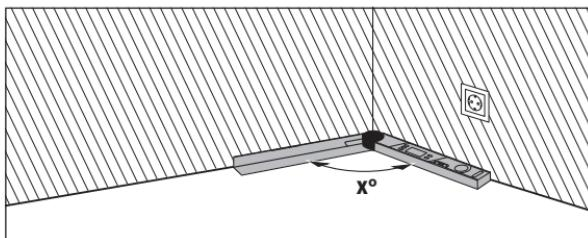
Jeżeli elementy te mają zostać dopasowane do jakiegoś kąta (np. w przypadku listew podłogowych), należy pomierzyć narożnik  $X^\circ$  przykładać ramie stałe i odchylane. W przypadku kątów stałych (np. rama do obrazu) ramie stałe i ramie odchylane należy tak ustawić, by pożądany kąt został wyświetlony na wyświetlaczu.
