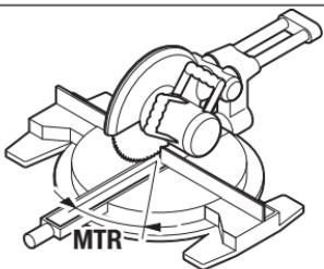
Pritisnite ponovo taster **7**. Na displeju se pojavljuje „**MTR**“ i izračunati horizontalni ugao iskošenja za testeru za presecanje i iskošenje.
