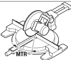
Stiskněte znovu tlačítko 7. Na displeji se objeví „**MTR**“ a vypočítaný horizontální úhel pokusu pro kapovací a pokosovou pilu.
