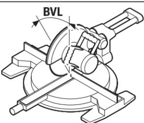
Apăsați din nou tasta **7**. Pe display apar „**BVL**“ și unghiul de înclinare în plan vertical calculat pentru ferăstrăul circular staționar.
