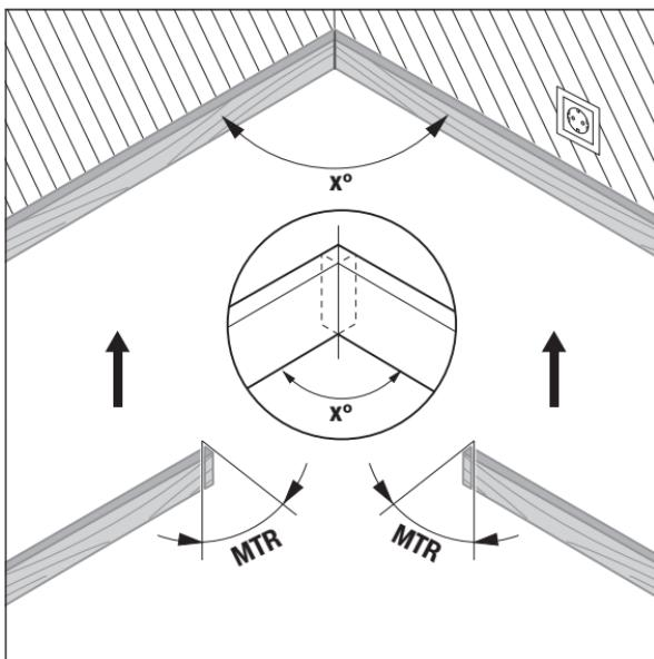
Рассчитывается горизонтальный угол распила «MTR» («Miter Angle»: горизонтальный угол распила), на который необходимо срезать 2 заготовки. Пильный диск находится при такой косой распиловке перпендикулярно к заготовке (вертикальный угол распила составляет  $0^\circ$ ).
