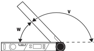
**Вимірювання «одностороннього скосу»**
