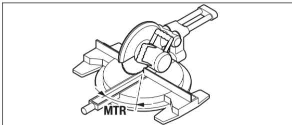
Pritisnite tipku „MTR“ 8. Sve dok držite pritisnutu tipku „MTR“ 8, prikazuje se izračunati horizontalni kut iskorištenja „MTR“, kojeg treba podešiti na pili za obrezivanje i za rezanje pod kutom. Istovremeno svijetli indikator „MTR“ na displeju.
