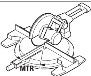
Ponovno pritisnite tipku **7**. Na displeju će se pojaviti „**MTR**“ i izračunat horizontalni kut kosog rezanja za pilu za odrezivanje i koso rezanje.
