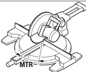
Вновь нажмите кнопку **7**. На дисплее отображается «**MTR**» и рассчитанный горизонтальный угол распила для торцовочно-усорезной пилы.
