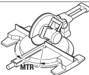
Stiskněte tlačítko „MTR“ 8. Dokud budete držet tlačítko „MTR“ 8 stisknuté, bude zobrazený vypočítaný vodorovný pokosový úhel „MTR“, který je nutné nastavit na kapovací a pokosové pily. Zároveň svítí indikátor „MTR“ na displeji.
