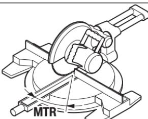
Apăsați tasta „**MTR**“ 8. Atât timp cât veți ține apăsată tasta „**MTR**“ 8, va fi afișat unghiul calculat de înclinare în plan orizontal „**MTR**“, care trebuie reglat la ferăstrăul circular staționar. Concomitent, pe display luminează indicatorul „**MTR**“.
