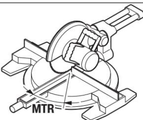
Pritisnite taster „**MTR**“ 8. Sve dok taster „**MTR**“ 8 držite pritisnut, prikazuje se obračunati horizontalni ugao iskošenja „**MTR**“, koji mora da se podeši na testeri za rezanje i iskošenje. Istovremeno zasvetli indikator „**MTR**“ na displeju.
