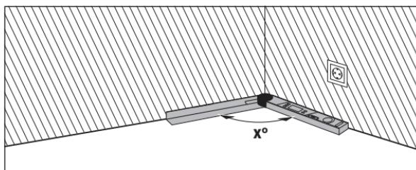
Ha a munkadarabokat egy sarokba kell beilleszteni (például padlólélékekhez), akkor a kihajtható és az alapszár felhelyezésével mérje meg a **x°** sarokszöget. Egy adott szögértékhez (például képeret) nyissa szét annyira a kihajtható és az alapszárat, hogy a kívánt szögérték kerüljön kijelzésre.
