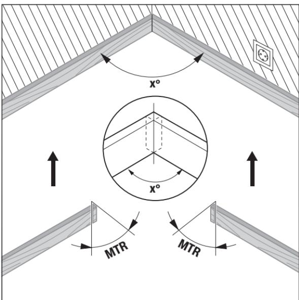
Ќе се пресмета хоризонталниот агол на закосување „MTR“ („Miter Angle“: хоризонтален агол на закосување), за кратење на двета дела што се обработуваат. Листот за пилата кај ваквото сечење со закосување стои вертикално на делот што се обработува (вертикалниот агол на закосување изнесува  $0^\circ$ ).
