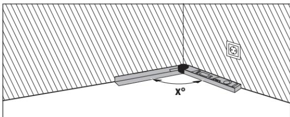
Ja abu priekšmetu salaidums jāpielāgo kādam stūrim (piemēram, savienojot grīdas listes), tad izmēriet šā stūra leņķi  $x^\circ$ , piespiežot tā malām mērinstrumenta kustīgo un bāzes mērstieni. Ja savienojums veidojams noteiktā leņķi (piemēram, izgatavojojot gleznu rāmju), attāliniet mērinstrumenta kustīgo mērstieni no bāzes mērstiena tik daudz, lai uz displeja parādītais rezultāts būtu vienāds ar vēlamā leņķa vērtību.
