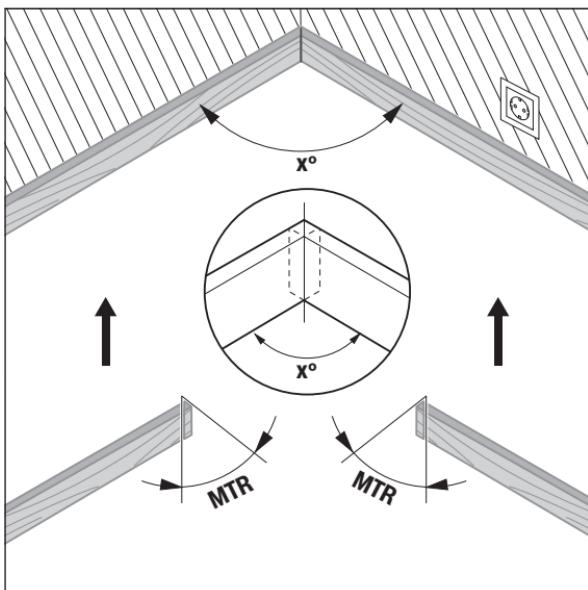
Välja arvutatakse horisontaalne kaldenurk „**MTR**“ („Miter Angle“: horisontaalne kaldenurk), mille võrra tuleb kahte toorikut lühendada. Saeketas on nende kaldlöigete puhul tooriku suhtes vertikaalselt (vertikaalne kaldenurk on  $0^\circ$ ).
