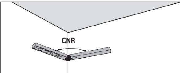
A sarokszög méréséhez helyezze fel a kihajtható és az alapszárat síkban a falakra, vagy állítson be a mérőműszeren egy ismert sarokszöget.
