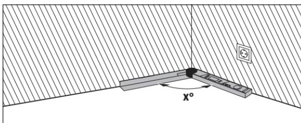
Если заготовки должны состыковываться в угле (напр., в случае плинтусов), измерьте угловой угол  $x^{\circ}$ , приложив откидное и основное плечо. Для заданных углов (напр., в случае с картинными рамами) разведите откидное и основное плечо настолько, чтобы на дисплее отобразился нужный угол.
