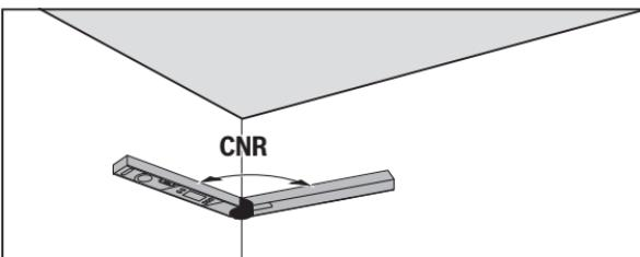
Sklopni in osnovni krak za merjenje vogalnega kota položite plosko na stene ali na merilni napravi nastavite znan vogalni kot.
