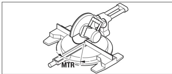
Натиснете отново бутона **7**. На дисплея се появяват символът «**MTR**» и изчисленияят ъгъл на скосяване в хоризонтална равнина за циркулярна машина.
