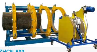
ZHCN-800 ZHCN-800E Диапазон диаметров: Ø500 - Ø800 Полная мощность набора: 12.000 Вт Общий вес набора: ~2.200 кг
