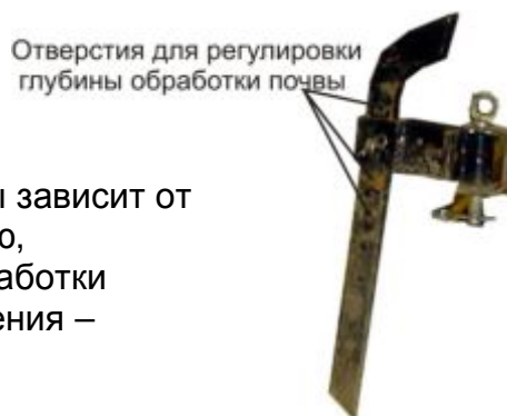
Рис. 8. Регулировка глубины обработки почвы
