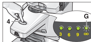
Fig. 5 : mise en circuit de la station
