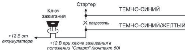
Схема подключения ТЁМНО-СИНЕГО провода для блокировки цепи зажигания автомобиля:
