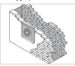
Для монтажа с воздуховодами ø100, 120, 150 мм и квадратными отверстиями соответствующих размеров.
