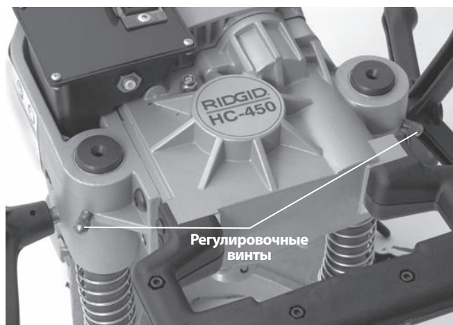
Рис. 13 – Регулировка регулировочных винтов
