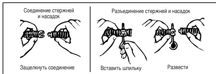
Рисунок 1. Соединение и разъединение стержней и насадок
