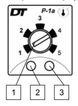
Настройка температуры в диапазоне 180–280°С производится с помощью поворотной кнопки на панели управления. Шкала сварочного аппарата оснащена номерами 1–5, их положения приблизительно отвечают следующим температурам:
