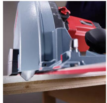
Фрезер MF-GF 90 позволяет выбирать 90° V-образные пазы с малым количеством пыли, что всего через несколько шагов после заключительной склейки позволяет получить красиво оформленный и стабильный угол.
