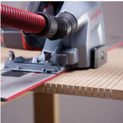
При помощи фрезера MF-SE 3 можно сделать три канавки за один проход. Использование такой технологии позволяет быстро и просто изготавливать изогнутые заготовки.
