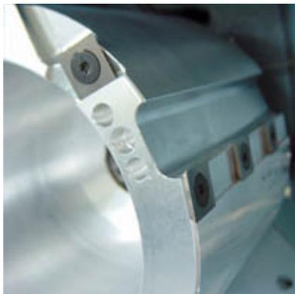
Фрезерная головка со сменными твердосплавными ножами, для предельного съёма материала и оптимальное удаление стружки.
