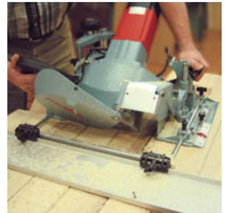
Фрезер ZK 115 Ес используется с направляющей шиной при серийной обработке.
