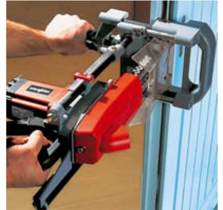
Легко и точно фрезеруется паз под замок на установленной двери.
