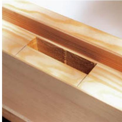
Паз длиной 78 мм и шириной 16 мм фрезеруется за один установ. Более длинное или широкое пазы выполняются с точностью до миллиметра посредством простой перестановки фрезера SKS 130.
