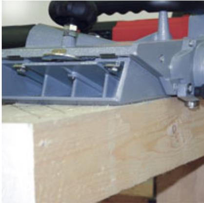
Максимальное использование ширины ножей обеспечивают специальные упорные ролики.
