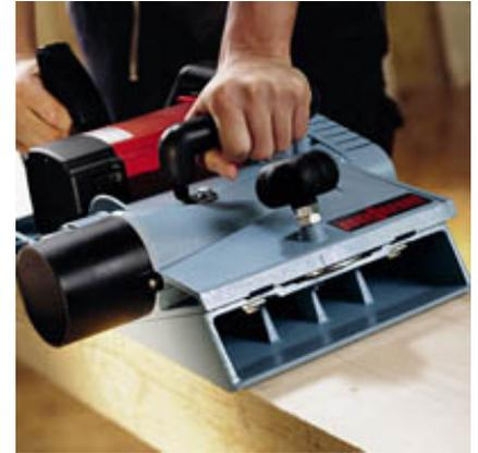
Новое устройство выброса стружек с возможностью подключения с помощью шланга диаметром 75/80 мм к аспирационной системе.
