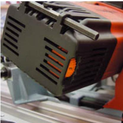
Регулировка скорости вращения пильного диска для распила различных материалов.
