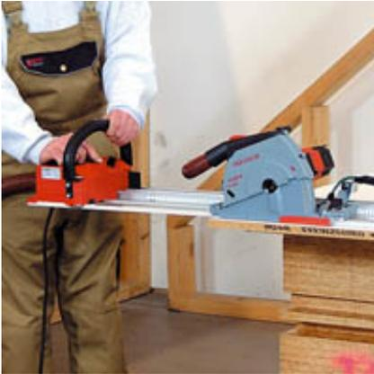
Благодаря автоматической подачи пилы, возможно обслуживание системы одним человеком, раскрой материала производить легко и быстро.
