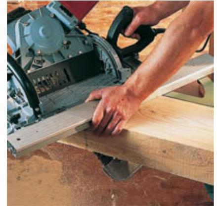
Идеальный инструмент для наклонных распилов. Универсальная направляющая шина включена в специальные принадлежности.
