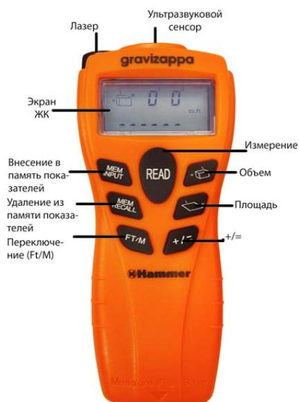
10. Повторное нажатие кнопки “READ” будет переключать прибор между данными измерений длины “L”, ширины “W” и высоты “H”.
