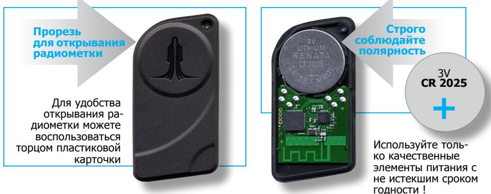
**!** При отрицательных температурах рабочие характеристики современных источников питания снижаются – замедляется химическая реакция. Из-за этого после длительного нахождения на морозе радиометка может не опознаться. Для восстановления работоспособности элемента питания достаточно согреть радиометку, а более точно – батарейку.
