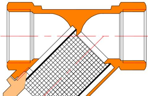
4.2. При установке следует соблюдать осторожность, не допуская замятия краев фильтрующего элемента.
