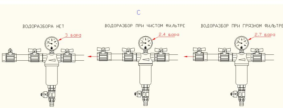
7.3. Промывка фильтра может производиться четырьмя различными способами:
