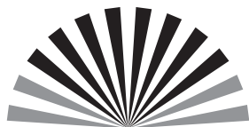
Диаграмма направленности зоны чувствительности датчика движения
