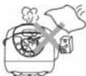
Не закрывайте отверстия для выхода пара кухонным полотенцем и другими предметами, чтобы избежать деформации и изменения цвета прибора.
