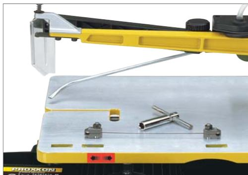
Обычные пилки с плоскими концами надежно крепятся с помощью двух патентованных зажимов. Такое крепление обеспечивает правильное положение пилки. Прорезь в столе служит шаблоном для установки пилки в зажимах.
