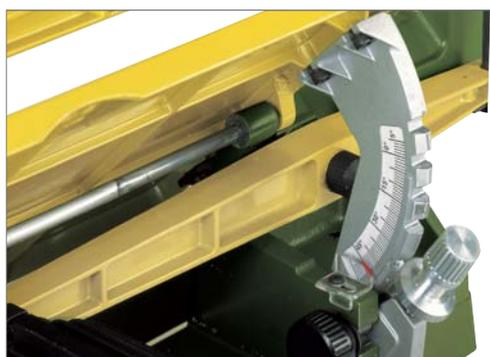
Угол наклона стола регулируется от 5° до 50°. Большие углубления на шкале на 0°, 10°, 20°, 30° и 45° для грубой настройки. Дополнительная тонкая настройка для усовых соединений осуществляется с помощью маховика.
