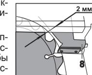
жение расклинвателя. Его плоскость должна совпадать с плоскостью диска, зазор между диском и расклинвателем должен быть 2–5 мм;
