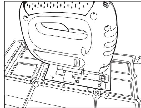
При необходимости, установите в отверстие 3 лобзик (с нижней стороны основания), используя прилагаемый фиксатор.
