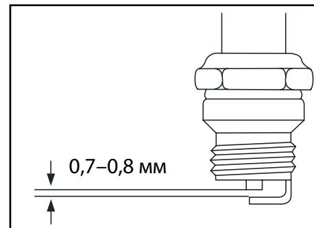
Зазор между электродами должен составлять 0,7–0,8 мм.
