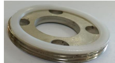
крепление настроечного диска новой конструкции
