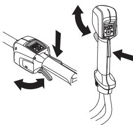
См. указания в разделе Запуск. Запустите машину на полную мощность. Отпустите переключатель и удостоверьтесь, что режущее оборудование останавливается и остается неподвижным.
