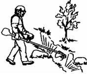
4. Выключайте двигатель, когда переходите на другой участок. Наденьте защиту ножа при транспортировке на режущий орган прежде, чем переносить машину на любое расстояние.
