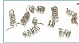
Свободно намотанная (витая) стружка - идеальные условия резания
