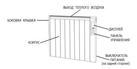
Для удобства пользователя конвектор используется в двух положениях — крепится на стену или устанавливается на пол с помощью колесиков.
