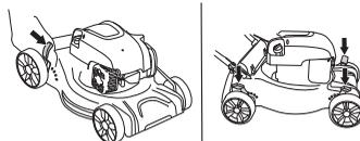
M40-125, M46-125 je opremljen s štirimi ročicami za nastavitve višine; po ena ročica na kolo.
