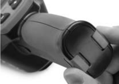
Figure 3 – Couvercle du logement de piles
