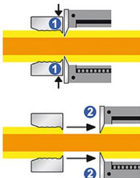
Режущие кромки на зажимных поверхностях (1) надежно удерживают зачищаемый провод, что предотвращает проскальзывание. Пара ножей для зачистки изоляции (2) режет без ручной регулировки на правильную глубину и чисто снимает изоляцию
