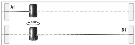
4. Перенесите прибор к противоположной стене, направьте на неё луч, отметьте точку B2. Метки B1, B2 должны находится на одной вертикали.
