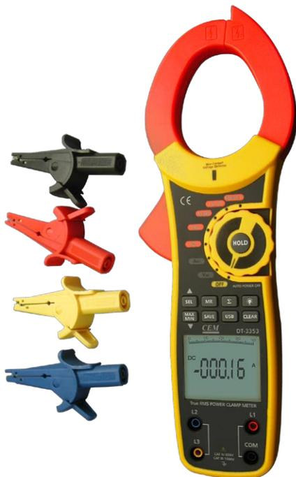
Токосные клещи DT-3353 предназначены для измерения параметров однофазных и сбалансированных трехфазных электросетей. Прибор позволяет осуществлять бесконтактные измерения силы тока и контактные измерения электрических параметров (напряжения, активной, полной и реактивной мощностей, коэффициента мощности  $\cos\theta$ , угла фазы и активной энергии).
