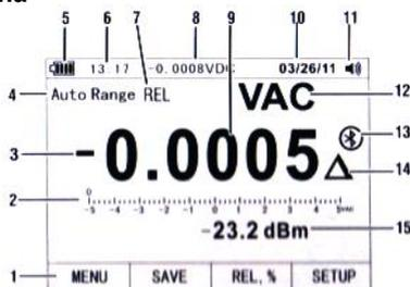
1. Функциональная кнопка. Указывает назначение кнопки, размещенной под индикатором.
