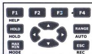
**F1F2F3F4** – выбор функций в режиме, который установлен поворотным переключателем.
