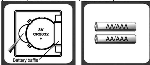
Для установки или замены батарейки – откройте отсек для батареек. Устанавливая батарейку, следите за соблюдением полярности.
