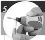
5. Продолжая удерживать кнопку блокировки, затяните цанговую гайку с помощью цангового ключа. Не прикладывайте чрезмерное усилие к ключу!
