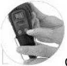
Скорость вращения шпинделя отображается на электронном дисплее, расположенного на торцевой части гравера. Кнопками, расположенными под дисплеем, можно регулировать скорость вращения: «+» увеличивает скорость вращения, «-» - уменьшает ее. Каждое нажатие кнопки изменяет скорость на 1 000 оборотов в минуту.
