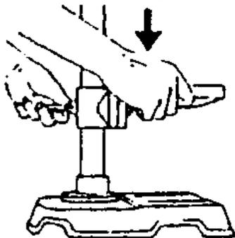
Регулировка угла наклона вертикального стола
