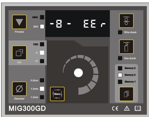
Изображение 12 : неисправный дисплей механизма подачи проволоки
