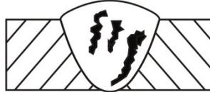
Резкое охлаждение конструкции;
