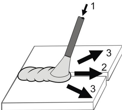
**Прямолинейное перемещение (2)** вдоль оси шва обеспечивает необходимую скорость сварки и качественное формирование шва. Скорость этого движения зависит от силы тока, диаметра электрода, скорости его плавления, вида шва и других факторов. При отсутствии поперечных движений электрода получается узкий шов (ниточный валик) шириной примерно 1,5 диаметра электрода. Такие швы применяют при сварке тонких листов, наложении первого (корневого) слоя многослойного шва, сварке способом опирания и т.д.
