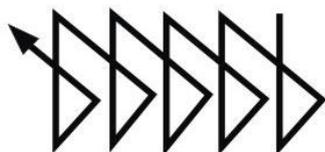
Применяют для угловых швов с катетом более 6 мм и стыковых швов со скосом кромок в любом пространственном положении. Дает хороший провар корня шва.
