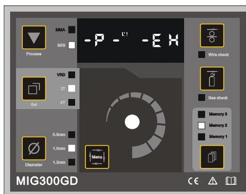
Изображение 14 : Отображение неисправности функции защиты от перенагрева
