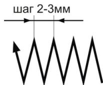
Прямые зигзагообразные движения применяют для получения наплавочных валиков при сварке встык без скоса кромок в нижнем положении и если нет вероятности прожечь деталь.
