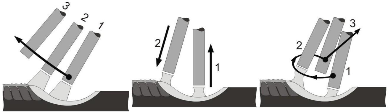
В конце шва нельзя обрывать дугу сразу. Электрод перемещают на край сварочной ванны (1,2) и затем быстро отводят (3) от кратера.
