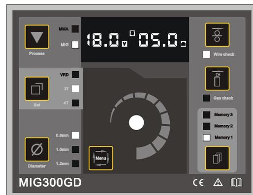
Изображение 6: Дисплей проверки проволоки при MIG сварки
