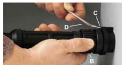
3. Надавливая ключом, плотно затяните плазмоторн в гнезде, вращая гайку плазмоторна. Выньте ключ. Плазмоторн зафиксируется в гнезде.
