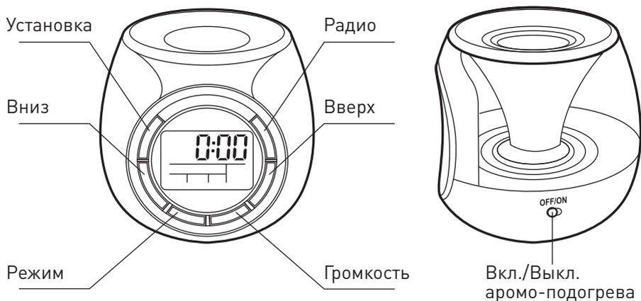
Рис.3.1. Назначение кнопок будильника
