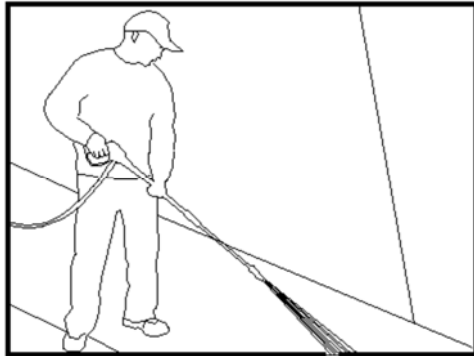
Рис. 6 - Оптимальный угол распыления воды относительно поверхности
