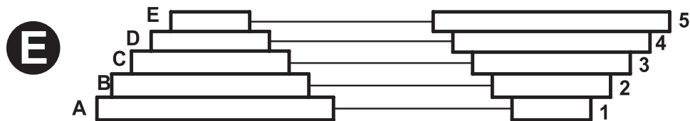
Рисунок E — схема настройки необходимой частоты вращения шпинделя станка.
