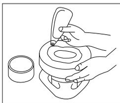
2. Равномерно нанести полироль по полировальнику. Не наносить полироль непосредственно на полируемую поверхность.
