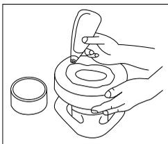
7. Заменить полировальный чехол с коротким ворсом на чехол с более длинным ворсом и натянуть его на полировальную подушку. Удостоверьтесь в его чистоте. Удалить слой полироли в том же порядке, в каком он наносился.
